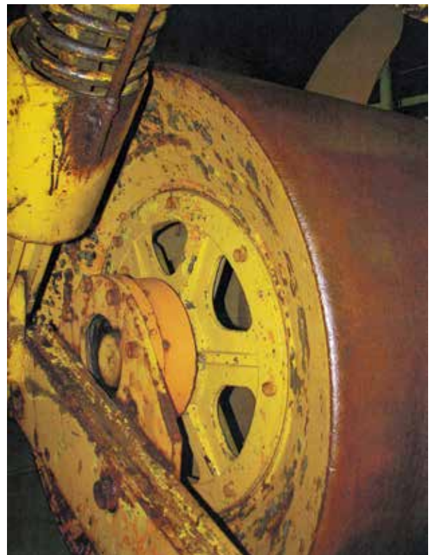
Traktoren er utstyrt med vibrasjonsvals bak.
